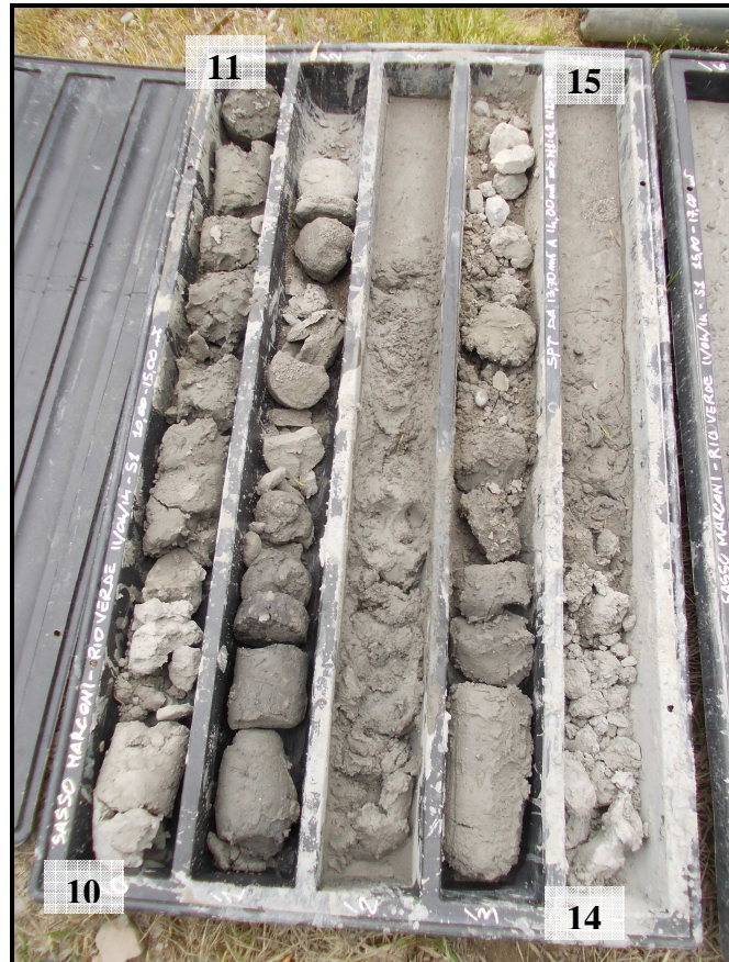
Foto 7 – Sondaggio 1/2014- Sito Via Rio Verde. Cassetta dei campioni prelevati, a carotaggio continuo, da 10,00 m a 15,00 m. Si noti come, pur dimostrandosi in situ mediamente addensate o cementate (difficoltà di avanzamento del carotiere), le sabbie arenacee si presentano disgregate a causa della rotazione della corona della testa del carotiere e dell'utilizzo dell'acqua di raffreddamento.
