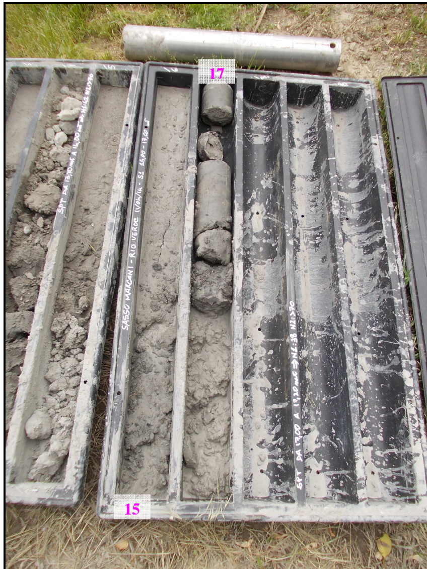
Foto 8 – Sondaggio 1/2014- Sito Via Rio Verde. Cassetta dei campioni prelevati, a carotaggio continuo, da 15,00 m a 17,00 m. Si noti, anche in questo caso, come anche il limo argilloso (debolmente sabbioso), pur dimostrandosi in situ compatto, si presenti disgregato a causa della rotazione della corona della testa del carotiere e dell'utilizzo dell'acqua di raffreddamento.
