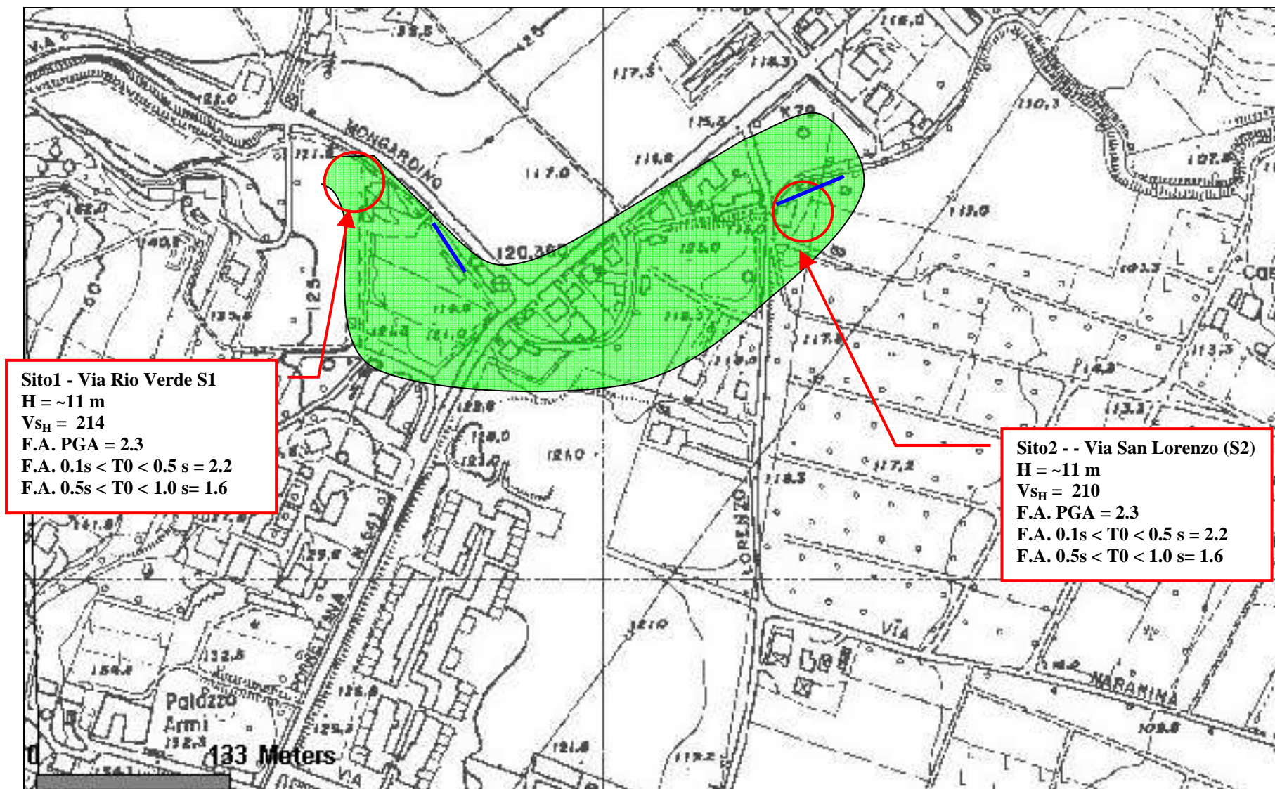
Figura 8:- PSC- Sasso Marconi – Carta di microzonazione sismica (su estratto CTR 1:5000) dell'area Via Rio Verde –Via San Lorenzo per i due siti indagati. Dai risultati delle indagini si può ipotizzare che l'area retinata in VERDE presenti gli stessi fattori di amplificazione sismica dei due siti indagati.
