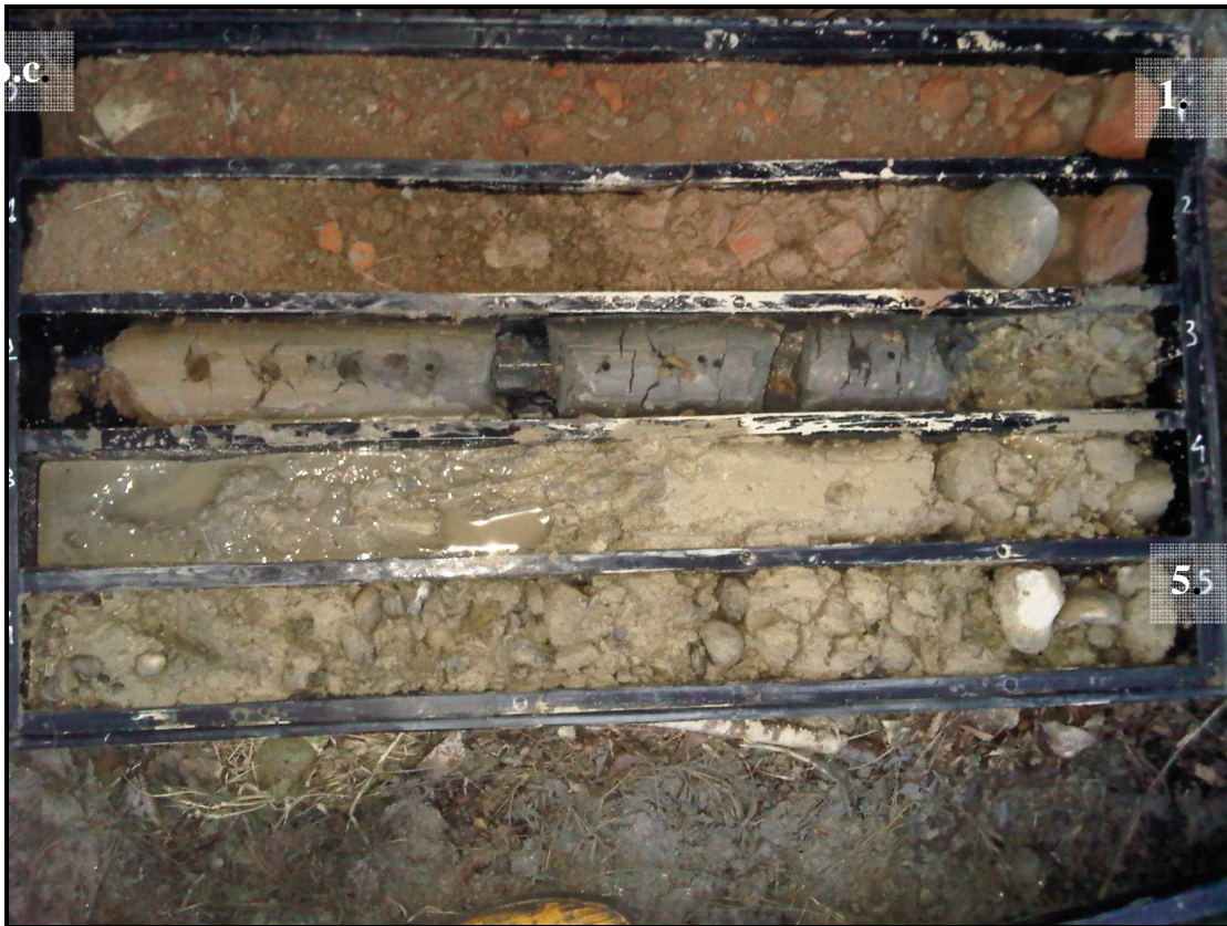
Foto 11 – Sondaggio S2pz/2011- Sito Via San Lorenzo. Cassette dei campioni prelevati, a carotaggio continuo, dal p.c. a – 5,00 m. In S2pz/2011 è stato installato un piezometro a tubo aperto. Si noti, nei primi due metri di perforazione, la presenza di materiale di riporto (frammenti di laterizio).
