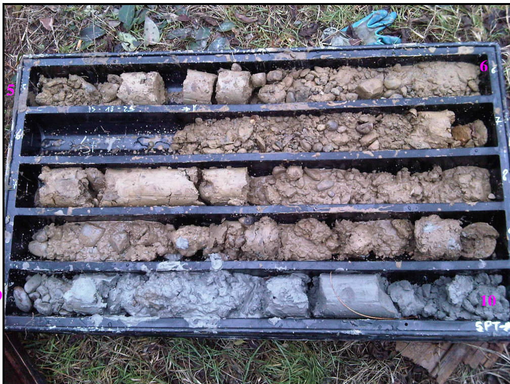
Foto 6 – Sondaggio S1pz/2011 –Sito Via Rio Verde: Cassetta dei campioni di terreno (da -5,00 m a -10,00 m) prelevati, a carotaggio continuo, nell'anno 2011.
