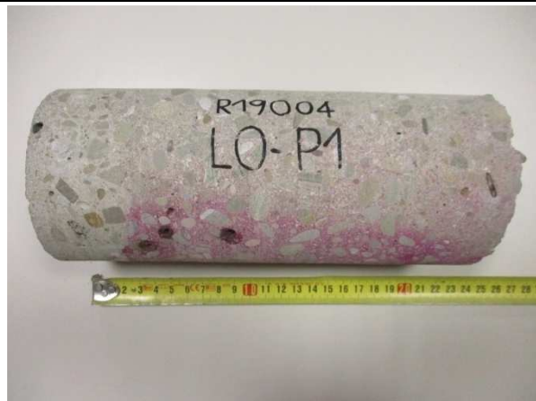
Analisi della profondità di carbonatazione eseguita sul campione di calcestruzzo prelevato dal pilastro B05 al piano terra.
